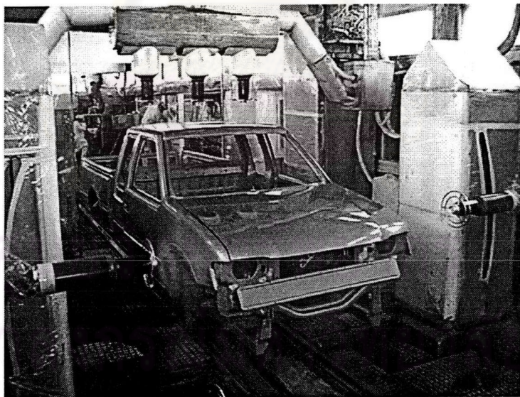
รูปที่ 1.1 ห้องพ่นสีรถยนต์
