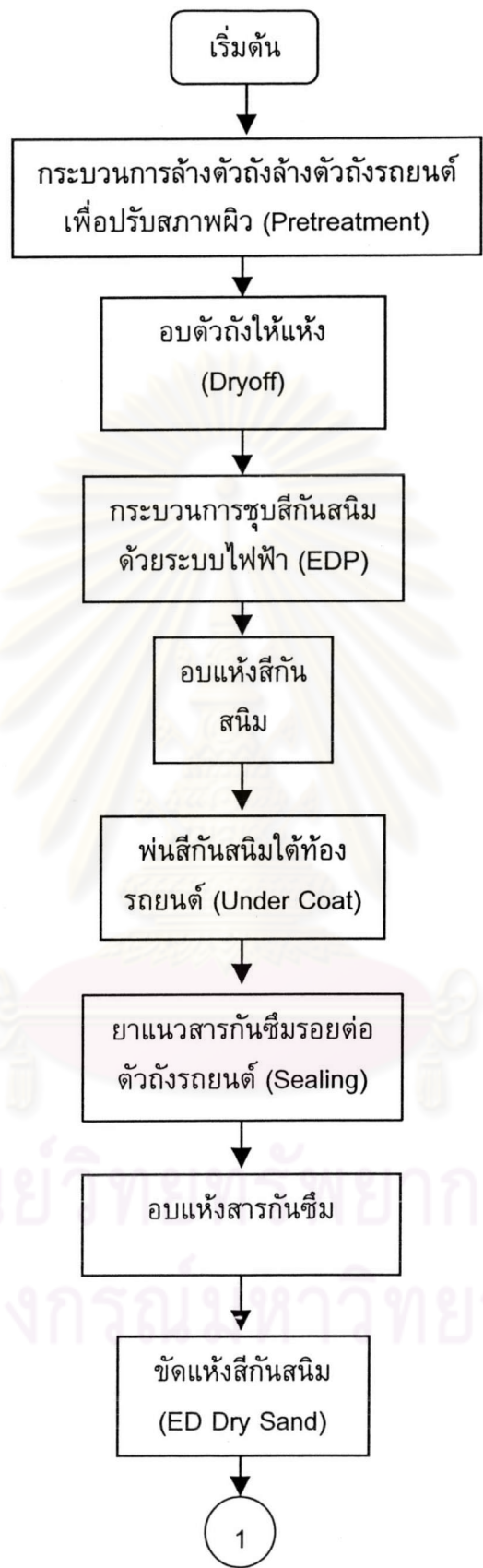
รูปที่ 1.2 แสดงกระบวนการผลิตของโรงงานพ่นสีรถยนต์ตัวอย่าง
