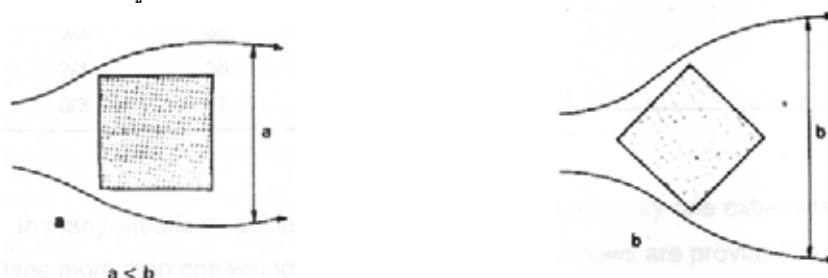
รูปที่ 2-10 แสดงขอบเขตของพื้นที่เงาลมเมื่อกระแสลมพัดมาในทิศทางตั้งฉากและทำมุม 45 องศากับอาคาร (ที่มา: Koenigsberger, cited in Sutthipong Boonyou, 1999:71)
