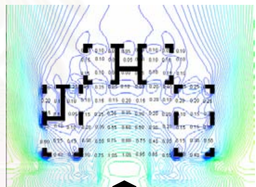
การทดลองที่ 3/1 ชั้นบน ระดับ+2.00 ลม 1.3 m/s พัดมาทำมุม 90 องศากับด้านหน้าอาคาร(0องศา)
