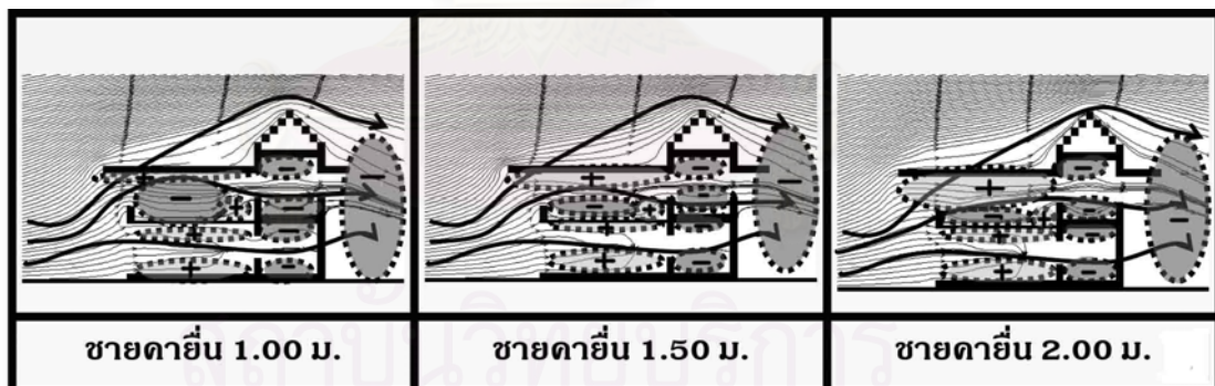
รูปที่ 5-11 เปรียบเทียบลักษณะการไหลเวียนกระแสลมของบ้านพักอาศัยล้อมชานกลุ่มอาคารต่อเนื่อง กรณีระยะยื่นชายคาต่างๆ เมื่อวางกลุ่มอาคารให้ชานตั้งฉากกับทิศทางกระแสลมภายนอก
