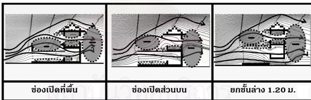
รูปที่ 5-8 เปรียบเทียบลักษณะการไหลเวียนกระแสลมของบ้านพักอาศัยล้อมชานกลุ่มอาคารต่อเนื่อง กรณีมีช่องเปิดที่พื้น, มีช่องลมเหนือช่องเปิด และยกใต้ถุนโล่ง เมื่อวางกลุ่มอาคารให้ชานตั้งฉากกับทิศทางกระแสลมภายนอก
