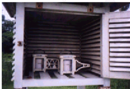
รูปที่ 2.4 ภาพแสดงเครื่องไฮโกรมิเตอร์แบบเส้นผม ติดตั้งภายในเรือนเทอร์มิเตอร์
