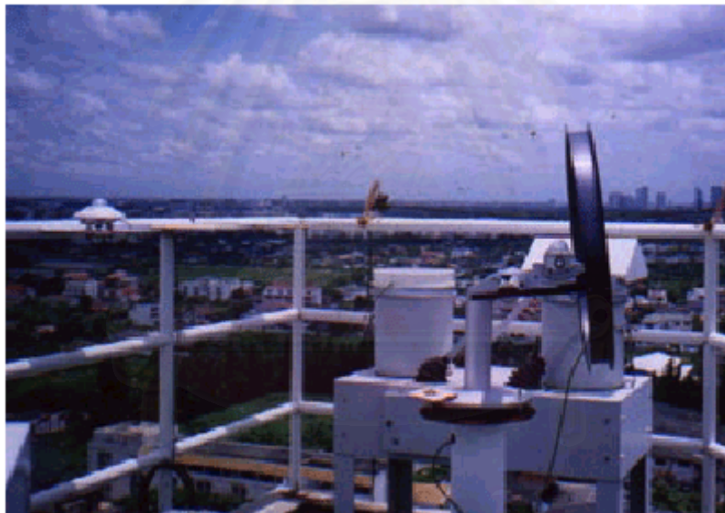
รูปที่ 2.9 ไพรานอมิเตอร์วัดรังสีรวมและไพรานอมิเตอร์วัดรังสีกระจายในแนวราบ
