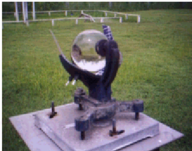
รูปที่ 2.10 รูปแสดงเครื่อง campbell-stokes sunshine recorder
