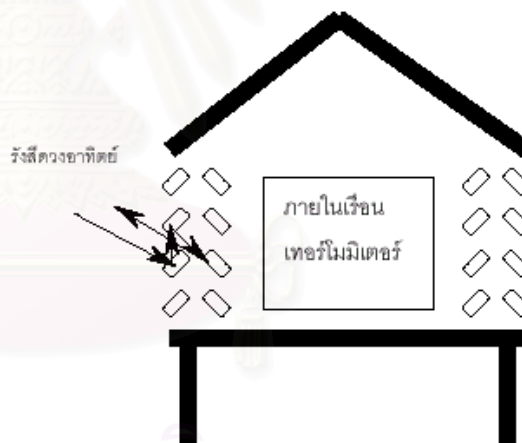
รูปที่ 2.3 รูปตัดแสดงเรือนเทอร์โมมิเตอร์
