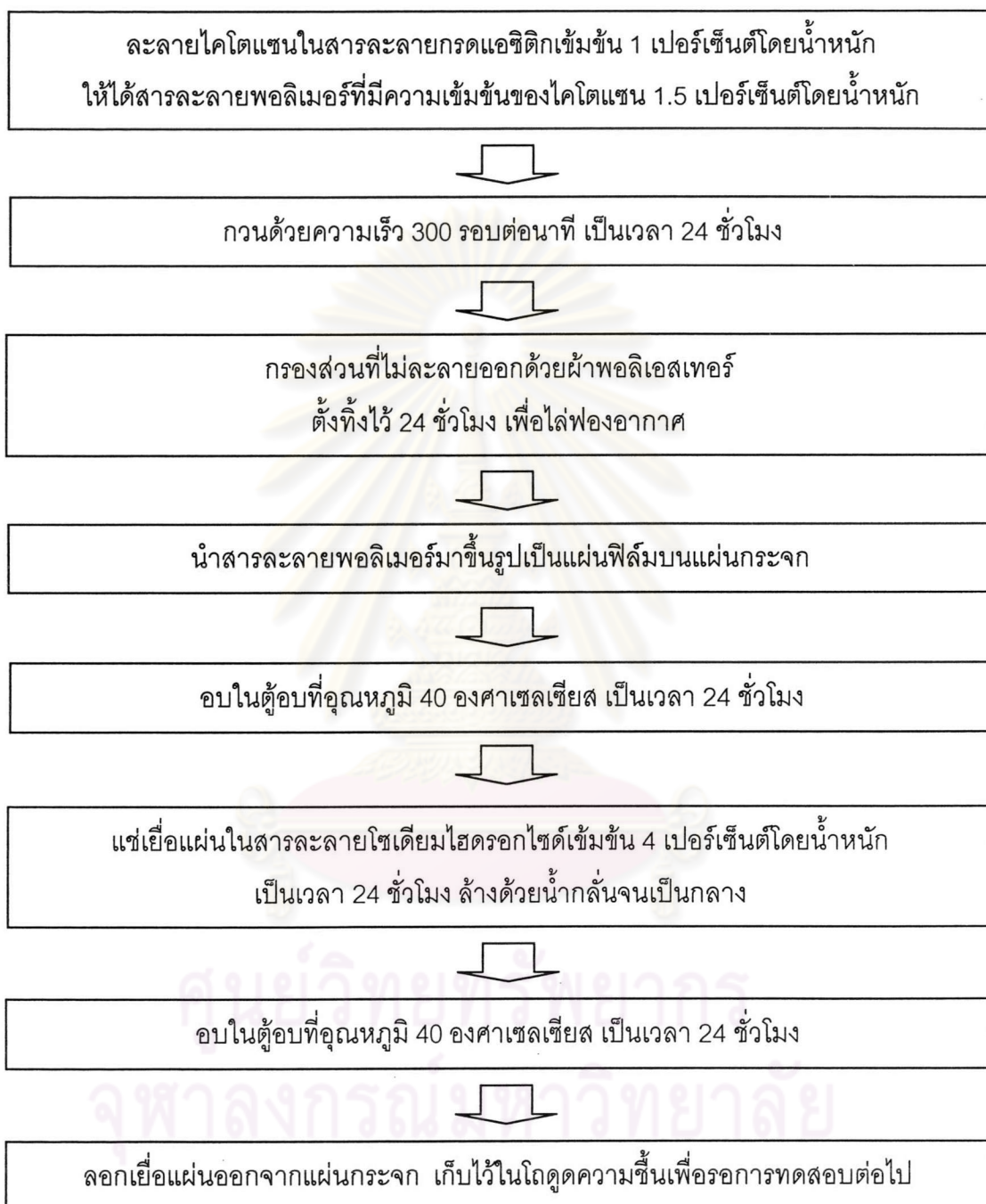
รูปที่ 3.1 แผนภาพวิธีการเตรียมเยื่อแผ่นไคโตแซน
