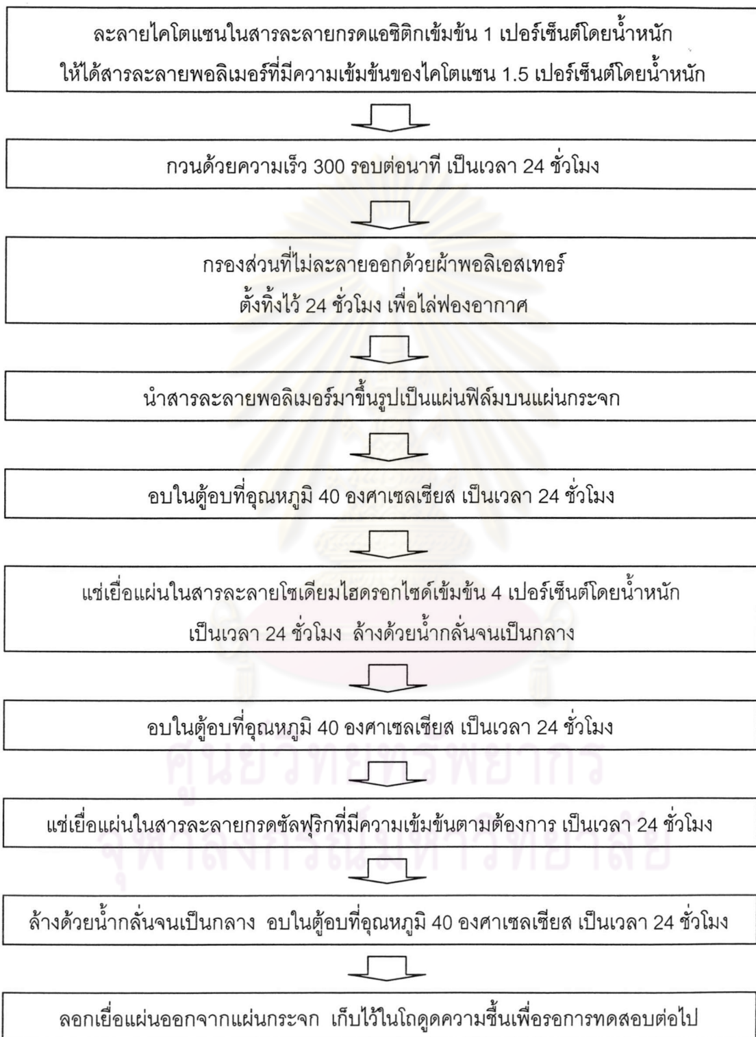
รูปที่ 3.2 แผนภาพวิธีการเตรียมเยื่อแผ่นโคโตนแซนที่ถูกทำให้เกิดโครงร่างตาข่าย โดยใช้กรดซัลฟูริกเป็นสารเชื่อมโยง
