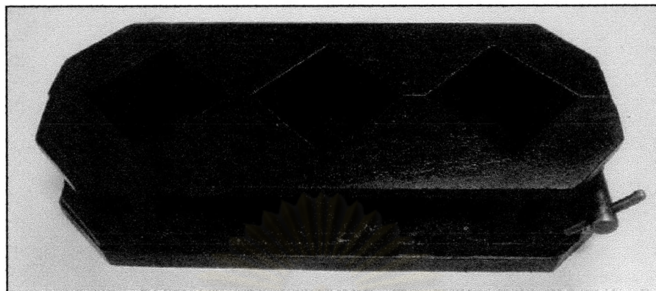
รูปที่ 3.3 แบบหล่อก้อนตัวอย่างลูกบาศก์ขนาด 5 x 5 x 5 ลูกบาศก์เซนติเมตร
