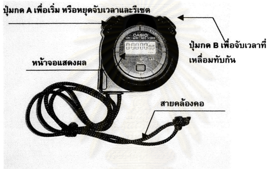
รูปที่ 4.3 แสดงภาพและส่วนประกอบของนาฬิกาจับเวลาแบบดิจิตอล
