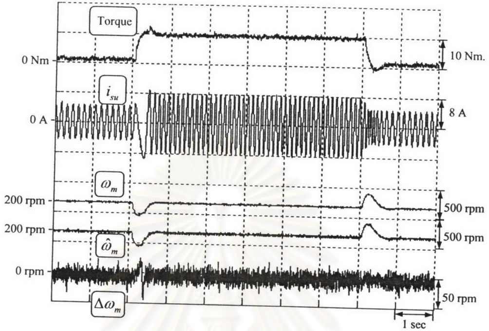
รูปที่ 3.14 ผลตอบสนองสถานะชั่วครู่ขณะใส่โหลดพิกัดเมื่อมอเตอร์ทำงานที่ความเร็ว 200 rpm ( \Delta R_s = +14\% )
