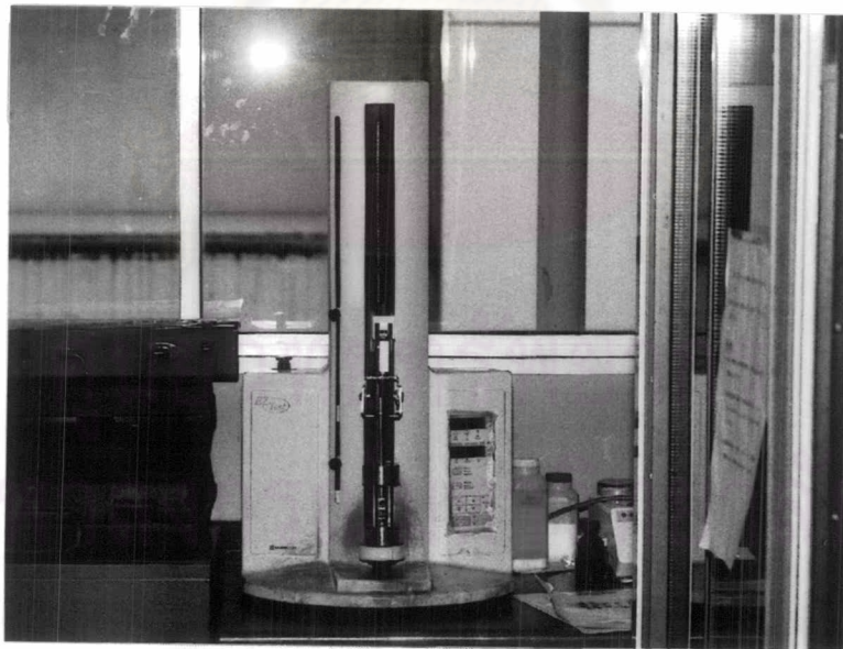
ภาพที่ 7 แสดงเครื่องทดสอบแรงดึงในระดับจุลภาค
