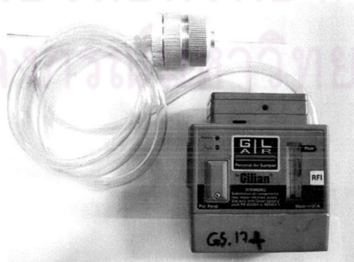
รูปที่ 3.3 Cascade impactor ที่ต่อกับเครื่องดูดอากาศชนิดตัวบุคคลพร้อมใช้งาน
