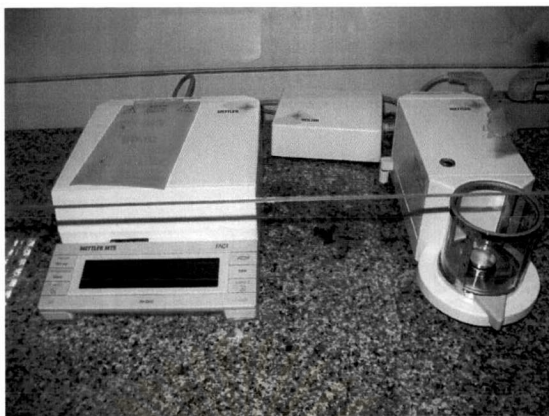
รูปที่ 3.4 เครื่องชั่งที่มีทศนิยม 6 ตำแหน่ง METLER UMT 5
