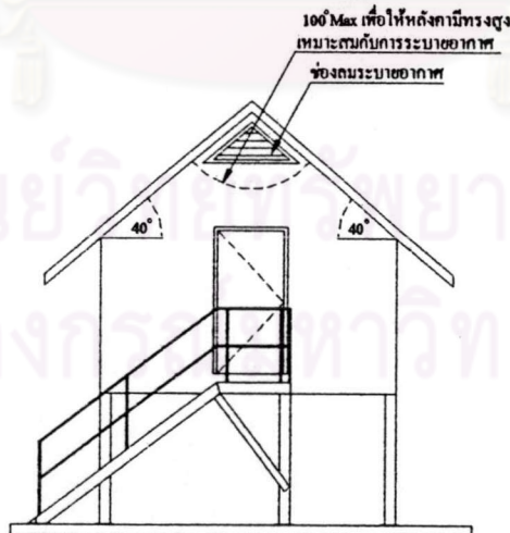
ภาพที่ 7-7 ตัวอย่างการลดความร้อนภายใน โดยการเพิ่มความสูงของหลังคาและช่องระบายอากาศ
