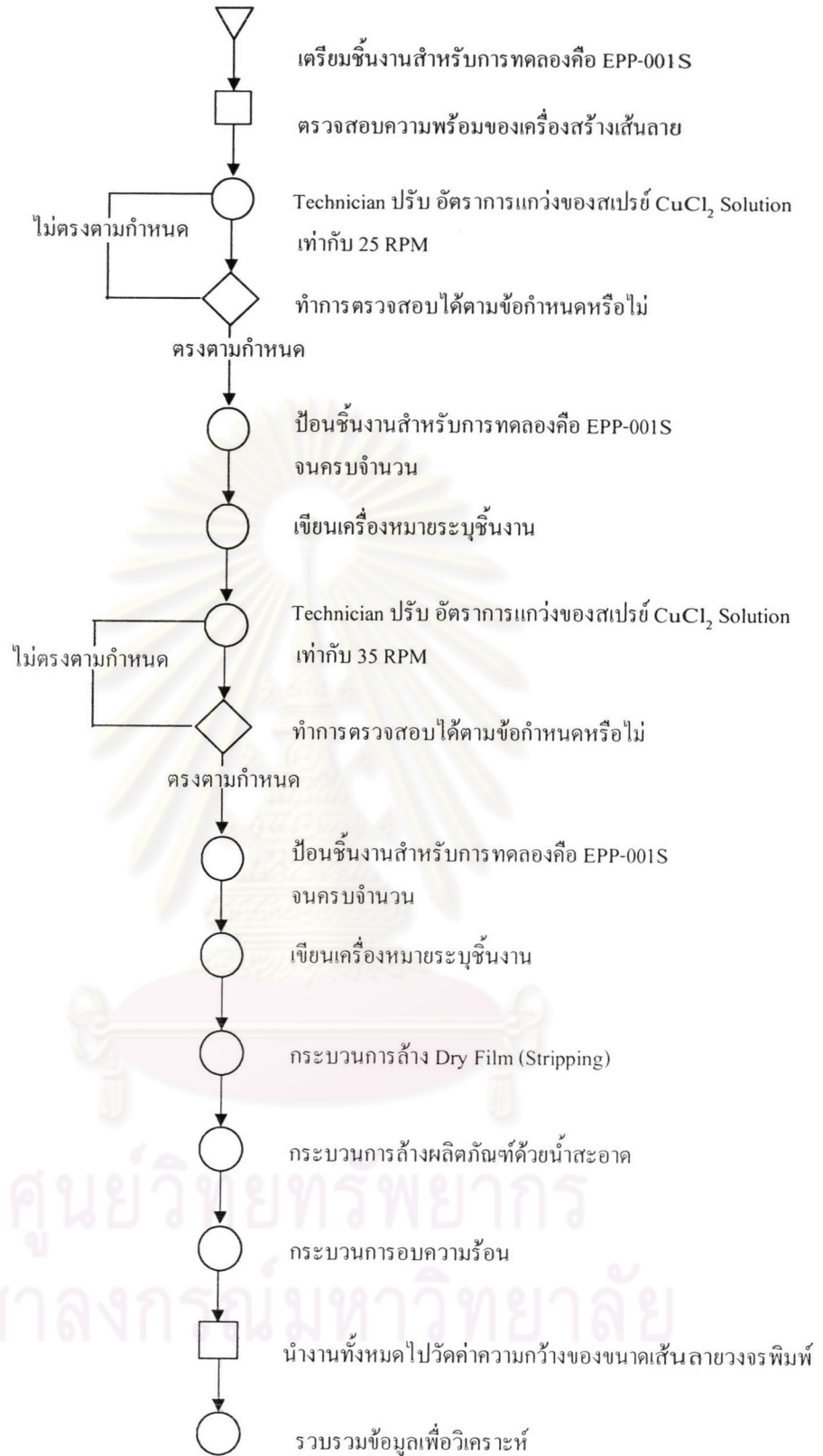
รูปที่ 5.1 ขั้นตอนการทดลองสำหรับอัตราการแกว่งของสเปรย์ของ CuCl 2 Solution กระบวนการสร้างเส้นลายวงจรพิมพ์
