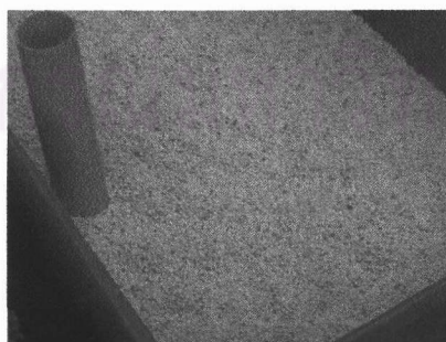
รูปที่ 3.11 การเทกรวดขนาดเล็กปิดทับอีกชั้น
