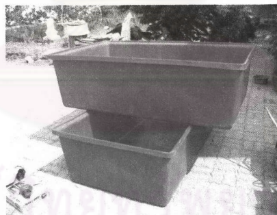
รูปที่ 3.4 กระบะพลาสติก ขนาดกว้าง 1 เมตร ยาว 1.7 เมตร ลึก 0.6 เมตร
