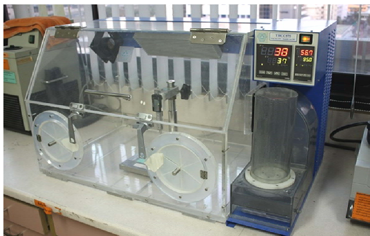
ภาพที่ 8 แสดงตู้ควบคุมอุณหภูมิที่มีเครื่องพีเนโตรมิเตอร์ติดตั้งอยู่ภายใน
