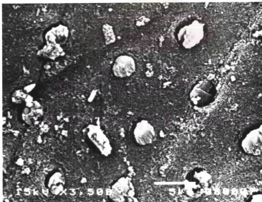
ภาพที่ 39 แสดงภาพขยายจุลทรรศน์อิเล็กตรอนแบบส่องกราดบนพื้นผิวด้านเนื้อฟันที่แตกหัก ในกลุ่มทดลอง DSC NL-SC ตำแหน่งที่ความล้มเหลวเกิดขึ้นที่รอยต่อระหว่างสารเรซินกับเนื้อฟัน
