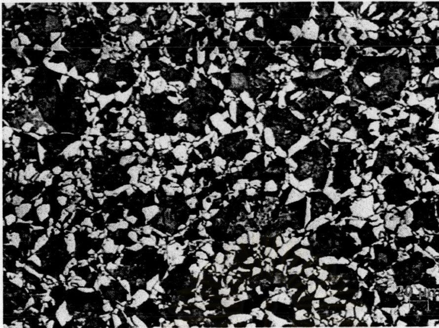
รูปที่ ก.9 โครงสร้างเฟอร์ไรท์-เพิร์ลไลท์ หลังการอบให้ร้อนขึ้นอีกที่อุณหภูมิ 1,150^{\circ}\text{C} รีดหยาบ 42% ที่อุณหภูมิ 1,100^{\circ}\text{C} และรีดละเอียดด้วยปริมาณ 53.3% ที่อุณหภูมิ 1,000^{\circ}\text{C} แล้วเย็นตัวด้วยอัตราการเย็นตัว 1^{\circ}\text{C}/\text{sec} . ไปม้วนเก็บที่อุณหภูมิ 500^{\circ}\text{C}/\text{sec} .
