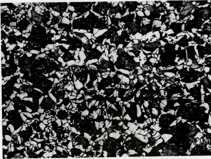
รูปที่ ก.3 โครงสร้างเฟอร์ไรท์-เพิร์ลไลท์ หลังการอบให้ร้อนขึ้นอีกที่อุณหภูมิ 1,150^{\circ}\text{C} รีดหยาบ 42% ที่อุณหภูมิ 1,100^{\circ}\text{C} และรีดละเอียดด้วยปริมาณ 53.3% ที่อุณหภูมิ 1,000^{\circ}\text{C} แล้วเย็นตัวด้วยอัตราการเย็นตัว 1^{\circ}\text{C}/\text{sec} . ไปมีวนเก็บที่อุณหภูมิ 400^{\circ}\text{C}/\text{sec} .
