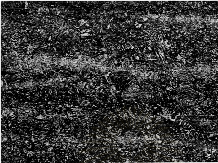
รูปที่ ก.7 โครงสร้างมาร์เทนไซต์ หลังการอบให้ร้อนขึ้นอีกที่อุณหภูมิ 1,150^{\circ}\text{C} รีดหยาบ 42% ที่อุณหภูมิ 1,100^{\circ}\text{C} และรีดละเอียดด้วยปริมาณ 53.3% ที่อุณหภูมิ 1,000^{\circ}\text{C} แล้วเย็นตัวด้วยอัตราการเย็นตัว 20^{\circ}\text{C}/\text{sec} . ไปม้วนเก็บที่อุณหภูมิ 400^{\circ}\text{C}/\text{sec} .
