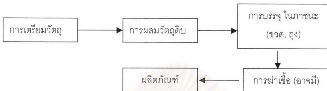
รูปที่ 4-2 กระบวนการผลิตของอุตสาหกรรมเชื่อม ดอง ผัก ผลไม้
