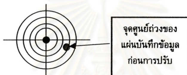
รูปที่ 1.4 แสดงรูปการจำลองผลของค่าความสมดุลที่จอแสดงผล(Monitor) หมายเหตุ : จุดศูนย์ถ่วงของแผ่นบันทึกข้อมูลก่อนการปรับ มีลักษณะแบบส้ม
