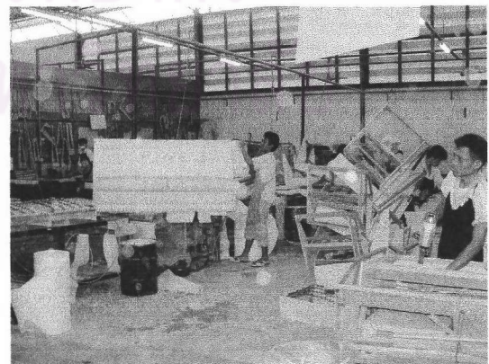
รูปที่ 5.16 มีการพันกาวติดฟองน้ำที่ฟุ้งกระจายไปเกาะส่วนต่าง ๆ ของอาคาร
