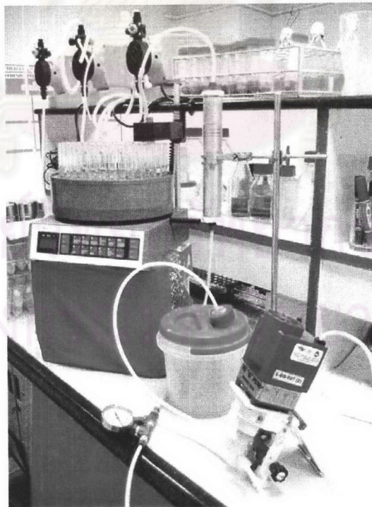
รูปที่ 3.10 ชุดอุปกรณ์การทดลองแบบคอลัมน์
