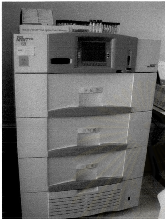
การเพาะเชื้อวัณโรคด้วยเครื่อง Automated MGIT 960 system
