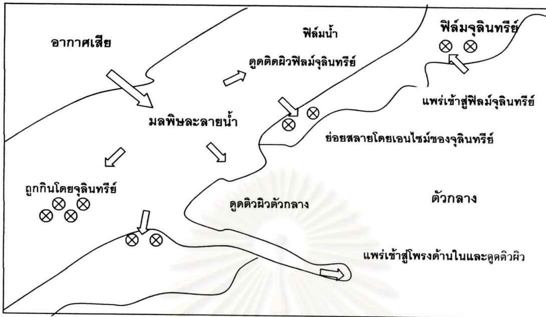
รูปที่ 2.2 การดูดซึมและดูดติดภายในเครื่องกรองชีวภาพ
