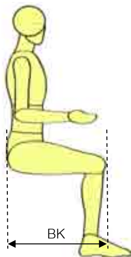
ภาพที่ ก.15 สัดส่วนร่างกายในตำแหน่งความยาวจากก้นกบถึงหัวเข่าด้านหน้าขณะนั่ง: BK (Buttock-knee length, Sitting)
