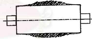
รูป ข. Thermal crown ตรงกลางสูงเกินไป
