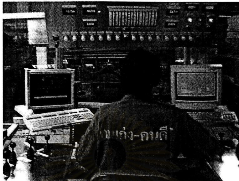
รูปที่ 1.3 แสดงห้องควบคุมการรีดโดยมีจอควบคุม Level 2 อยู่ด้านซ้ายมือ และจอควบคุม Level 1 อยู่ด้านขวามือ
