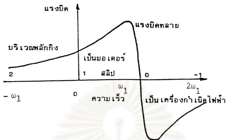
รูปที่ 2.2 เส้นโค้งลักษณะสมบัติระหว่างแรงบิด กับความเร็วของมอเตอร์เหนี่ยวนำ
