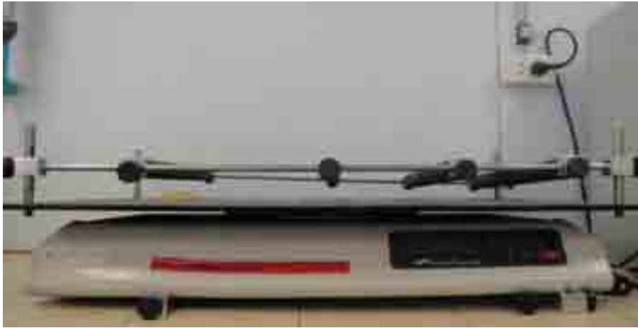
ภาพที่ ค-1 เครื่องเขย่าที่ปรับความเร็วรอบได้
