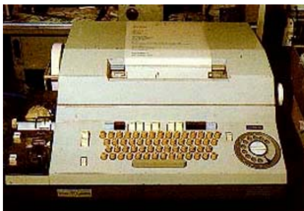
เครื่องโทรพิมพ์สำหรับบริการเทเล็กซ์หรือเรียกสั้นๆ ว่าเครื่องเทเล็กซ์
