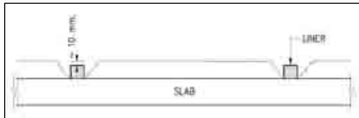
ภาพที่ 2-17 แสดงการวาง MORTARและLINER
