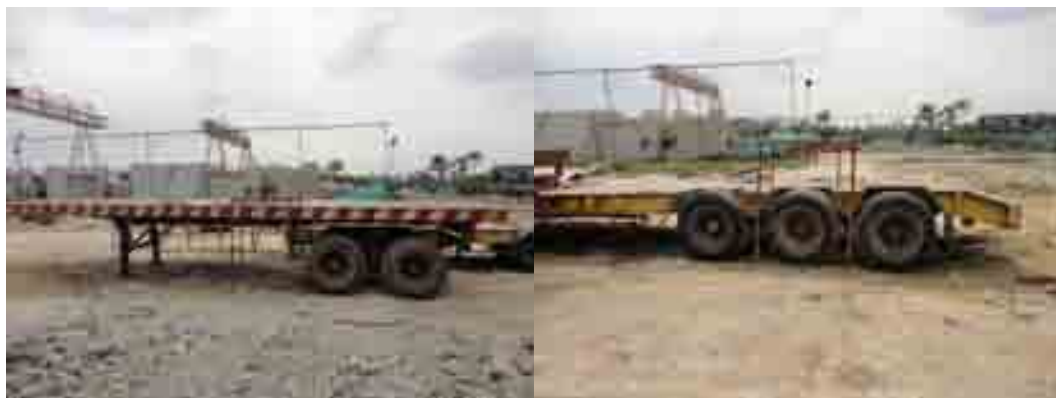
ภาพที่ 5-83 การเลือกใช้รถบรรทุกที่มีระดับความสูงของฐานแตกต่างกันระหว่างทางเรียบและ low base
