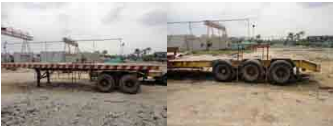
ภาพที่ 5-25 การเลือกใช้รถบรรทุกแบบทางเรียบและ low base ที่มีฐานแตกต่างกันเพื่อลดความสูงในการขนส่ง
