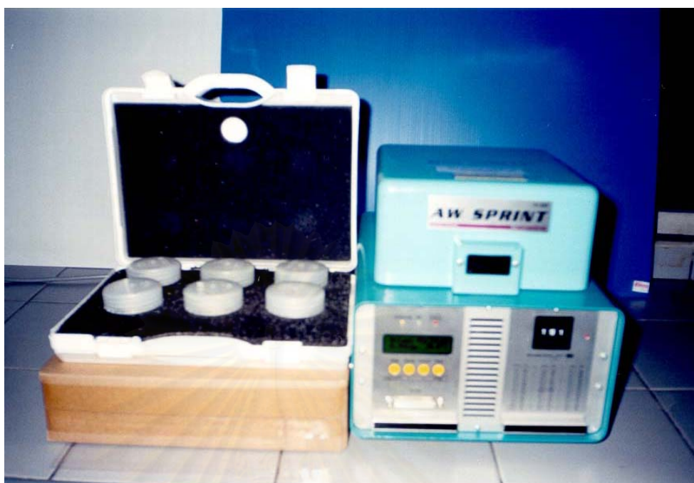
รูปที่ 5 เครื่องวัดค่า Water activity ที่ใช้ในการทดลอง A_w Sprint, Novasina TH-500
