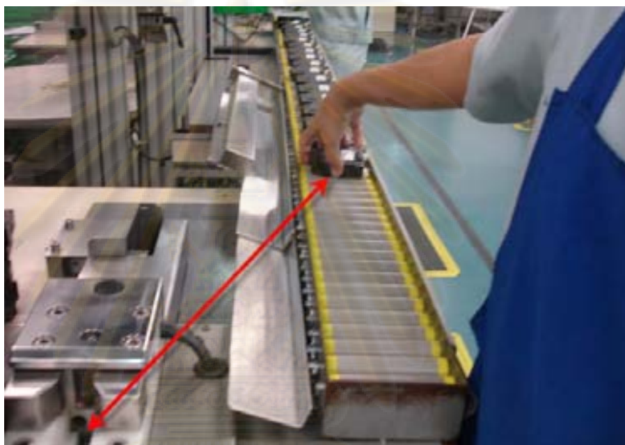
รูปที่ 4.11 การเคลื่อนไหวที่ไม่เหมาะสม: พนักงานต้องเอื้อมไปหยิบชิ้นงานจากรางลำเลียง
