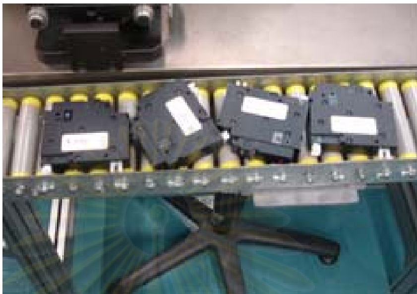
รูปที่ 4.13 ลักษณะเบรกเกอร์ที่อยู่บนรางลำเลียง ก่อนการปรับปรุง
