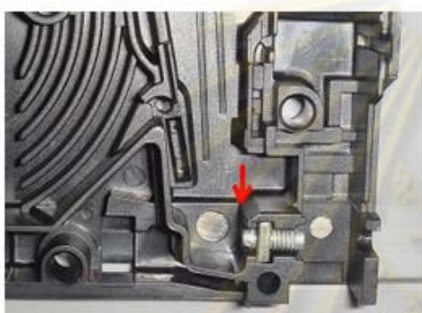
รูปที่ 4.18 (a) ระยะของตำแหน่ง Thermal screw 2 เกลียว (1.7 ซม.)
