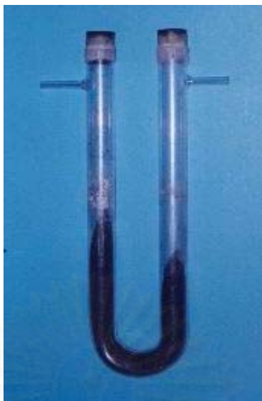
รูปที่ 3.4 ลักษณะเครื่องปฏิกรณ์สำหรับกระบวนการการดูดซับทางเคมี
