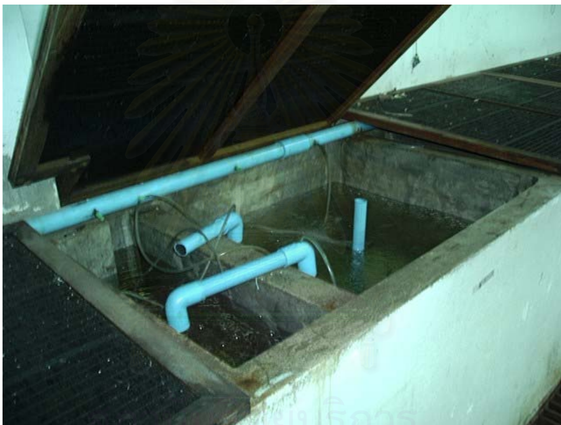
รูปที่ 7 บ่อคอนกรีตขนาด 75x75x60 (กว้างxยาวxสูง) เซนติเมตร ระบบน้ำหมุนเวียนแบบปิด การเก็บข้อมูล
