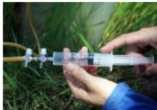
ดูดตัวอย่างก๊าซจาก chamber
