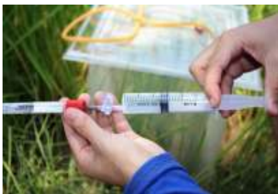
เก็บตัวอย่างก๊าซไว้ในหลอดสูญญากาศ
