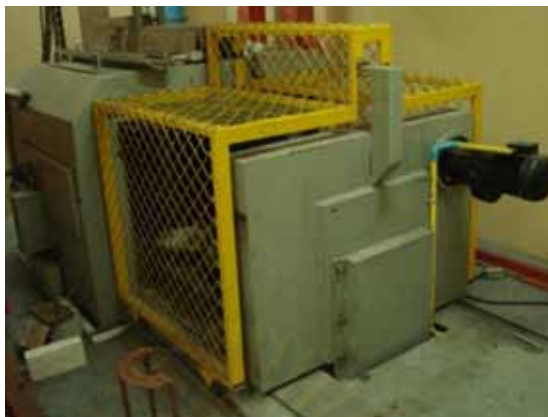
รูปที่ 3.1 เครื่องฉายรังสีแกมมาจากโคบอลต์-60 ที่ภาควิชานิวเคลียร์เทคโนโลยี จุฬาลงกรณ์มหาวิทยาลัย
