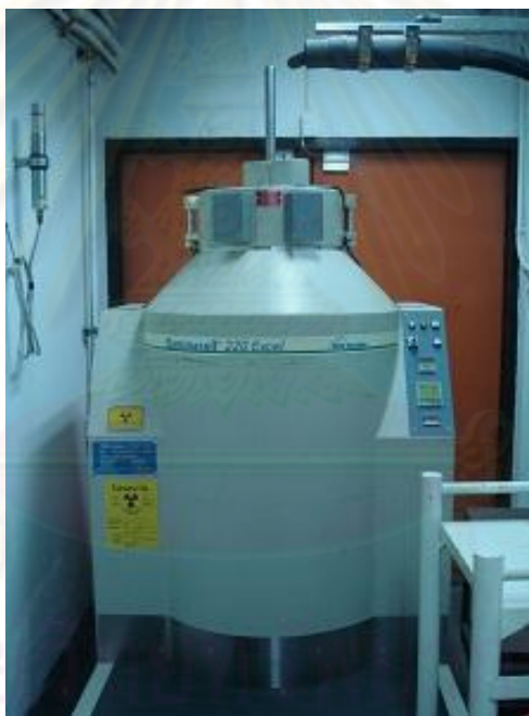
รูปที่ 3.5 เครื่องฉายรังสีแกมมาจากโคบอลต์-60 Gammacell 220 excel
