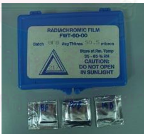
รูปที่ 3.2 อุปกรณ์วัดปริมาณรังสีแบบ Opti-Chromic Detector
