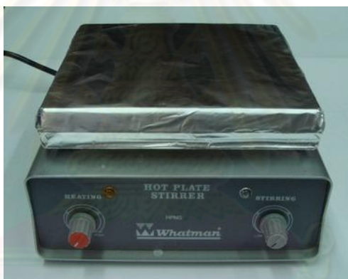
รูปที่ 3.12 เครื่องกวนสารแบบให้ความร้อน (Hot Plate Stirrer/Magnetic Stirrer)
