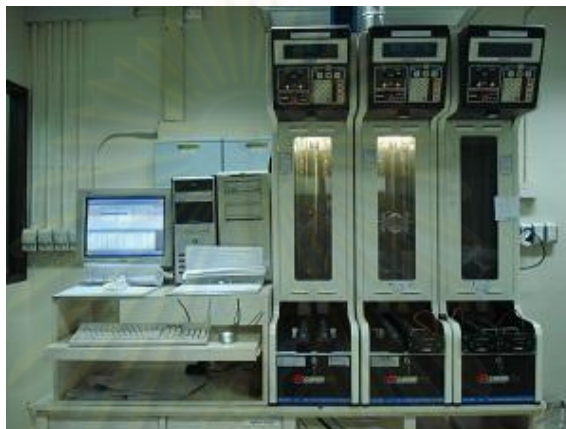
รูปที่ 3.8 เครื่องวัดความหนืดแบบอัตโนมัติ CANNON VISCOSITY METER รุ่น CAV-2000
