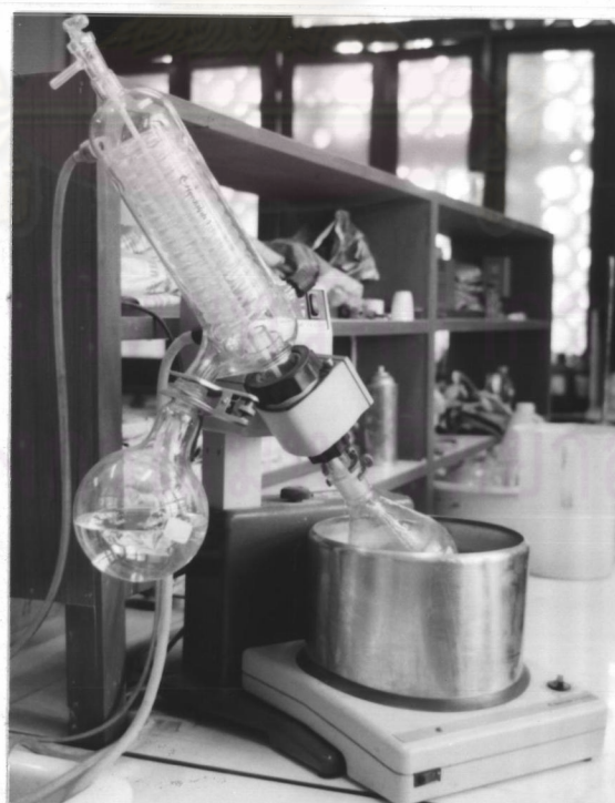
ภาพที่ 3.2 เครื่องระเหยแบบหมุน (Rotary evaporator)
