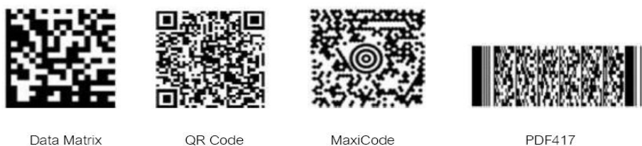
ภาพที่ 2-15 ตัวอย่างของรหัสแถบ 2 มิติชนิดต่างๆ ที่มา : ศูนย์ประสานงานการรักษาความปลอดภัยคอมพิวเตอร์ ประเทศไทย, 2549
