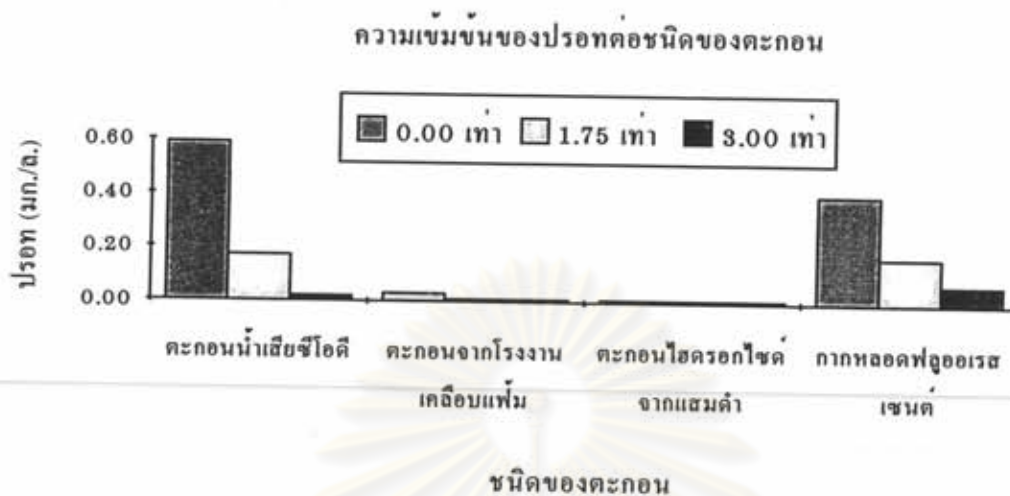
รูปที่ 5.30 กราฟแสดงความสัมพันธ์ระหว่างค่าความเข้มข้นของปรอทในน้ำสกัดหลังผ่านการทดสอบการชะละลายกับชนิดของตะกอน โลหะหนัก
