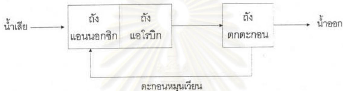
รูปที่ 1-1 แสดงส่วนประกอบของระบบแอคติเวดเติดค์สลัดจ์แบบเชื้อผสม
