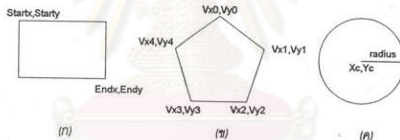
รูปที่ 4.6 ลักษณะกรอบวินโดวส์แบบต่างๆ (ก) สี่เหลี่ยมผืนผ้า (ข) หลายเหลี่ยม (ค) วงกลม
