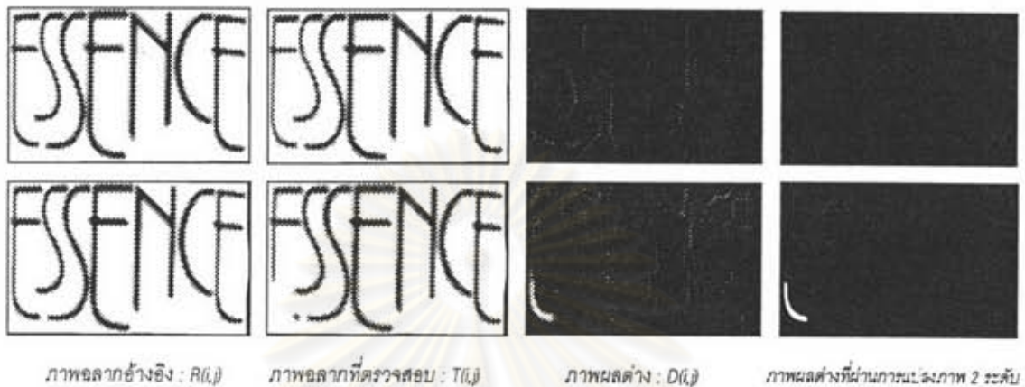
รูปที่ 4.23 ภาพผลลัพธ์ที่ได้จากการลบภาพและการดึงพิกเซลที่เป็นจุดบกพร่องโดยการแปลงภาพสองระดับ
