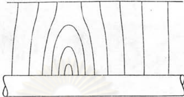
ภาพที่ 5.14 Potential Field Surrounding a Single Anodic Point
