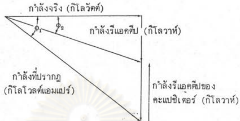
รูปที่ 39 การหาขนาดของคะปาซิเตอร์ในการปรับปรุง P.F.
