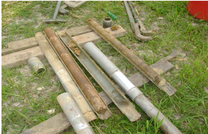
ภาพที่ 5.3 แสดงตัวอย่างดินที่ขุดเจาะขึ้นมาทดสอบ
