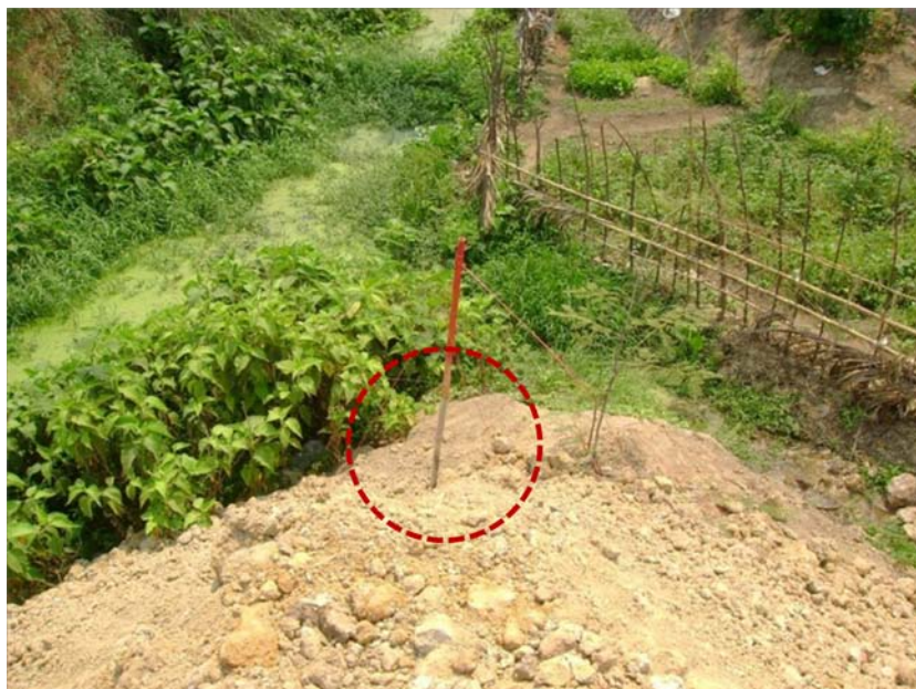
ภาพที่ 5.4 แสดงหมุดหลักเขตที่ดินสูญหายไม่ได้ตำแหน่ง
