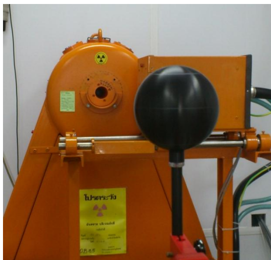
ภาพที่ ก.1 หัววัดรังสีมาตรฐานไอออนไนเซชันแฮมเบอร์ขนาด A6
