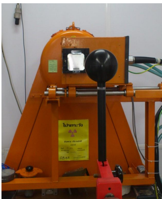
ภาพที่ ข.1 หัววัดรังสีมาตรฐานไอออไนเซชันแฮมเบอร์ขนาด A5
