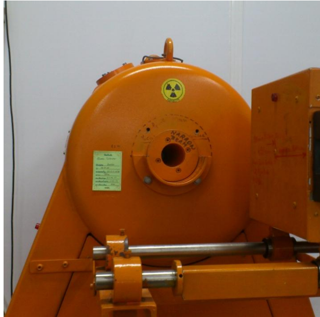
ภาพที่ ง.1 เครื่องฉายรังสี OB85 บรรจุวัสดุกัมมันตรังสี Cs-137 และ Co-60
