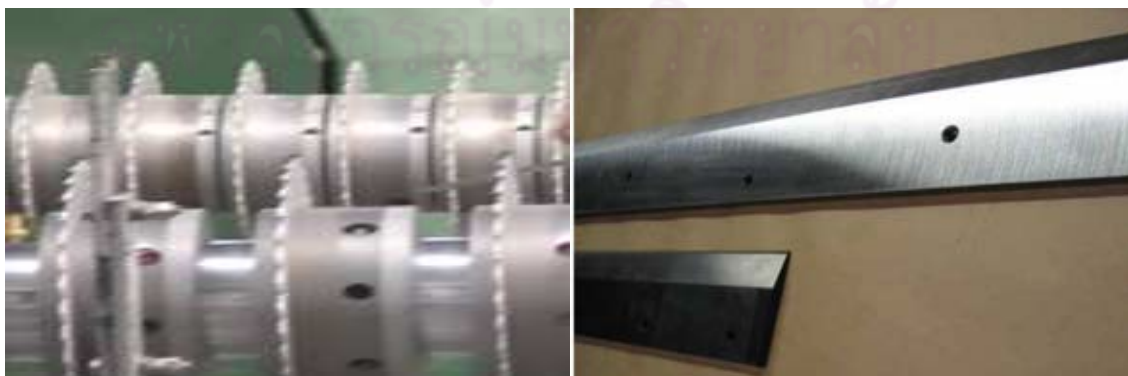
รูปที่ 2.10 การตัดด้วยใบมีดตัด
