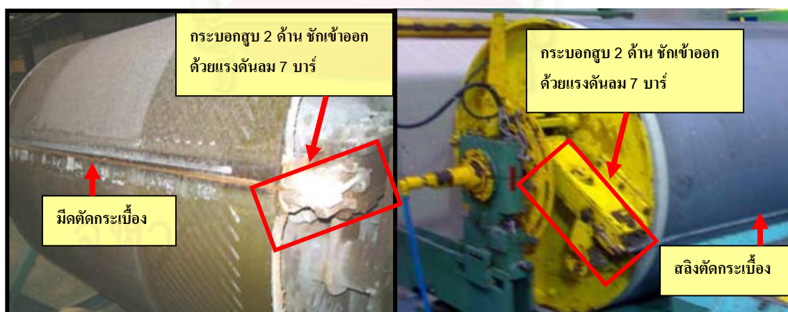
รูปที่ 4.15 การออกแบบจากใบมีดตัดกระเบื้องเป็นสลิ้งตัดกระเบื้อง
