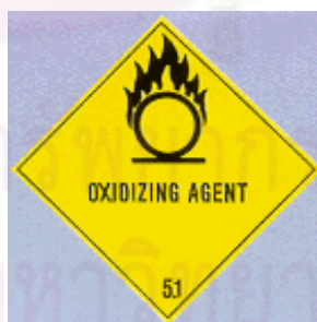
รูปที่ 2.10 สัญลักษณ์ของวัตถุอันตราย UN Class ประเภทที่ 5.1 (สารออกซิไดซ์)
