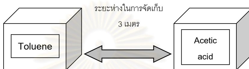
รูปที่ 5.1 ตัวอย่างของระยะห่างของการจัดเก็บวัตถุอันตรายในระยะห่าง 3 เมตร
