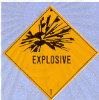
รูปที่ 2.2 สัญลักษณ์ของวัตถุอันตราย UN Class ประเภทที่ 1 (ระเบิดได้)
