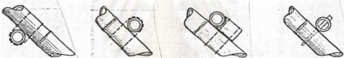
๒. แสดงการยึดกลอนไม้ไผ่ให้อยู่ในแนวเดียวกัน และการวางด้วยลวดและเตียบ
