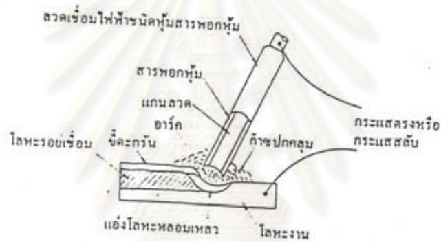
รูปที่ 2.20 แสดงการเชื่อมแบบอาร์คด้วยลวดเชื่อมชนิดสารพอกหุ้ม
