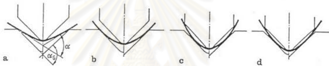
รูปที่ 2.10 การดัด V-bending 90^\circ ด้วยรัศมีพื้นชขนาดเล็ก
