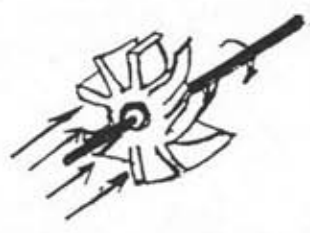
รูปที่ 3.5 แสดงมาตรวัดนํ้าแบบโพรเพิลเลอร์
