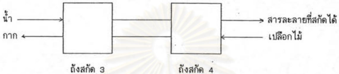
รูปที่ 3.8 แสดงถังสกัดที่ใช้ในการสกัด 2 ครั้ง
