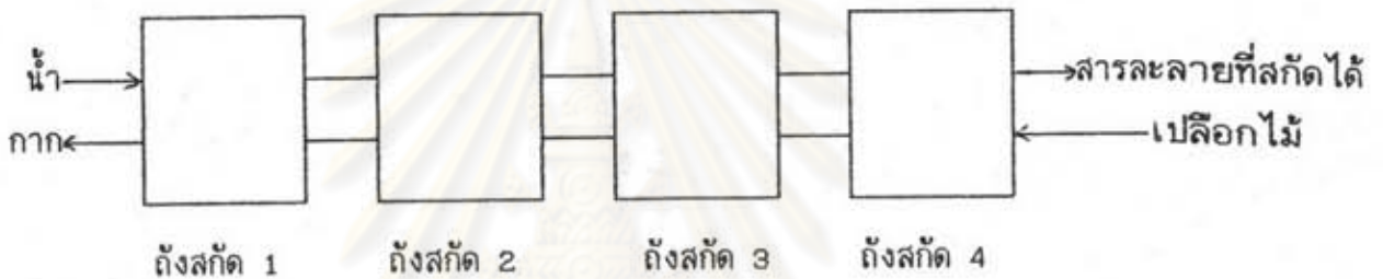
รูปที่ 3.10 แสดงถังสกัดที่ใช้ในการสกัด 4 ครั้ง
